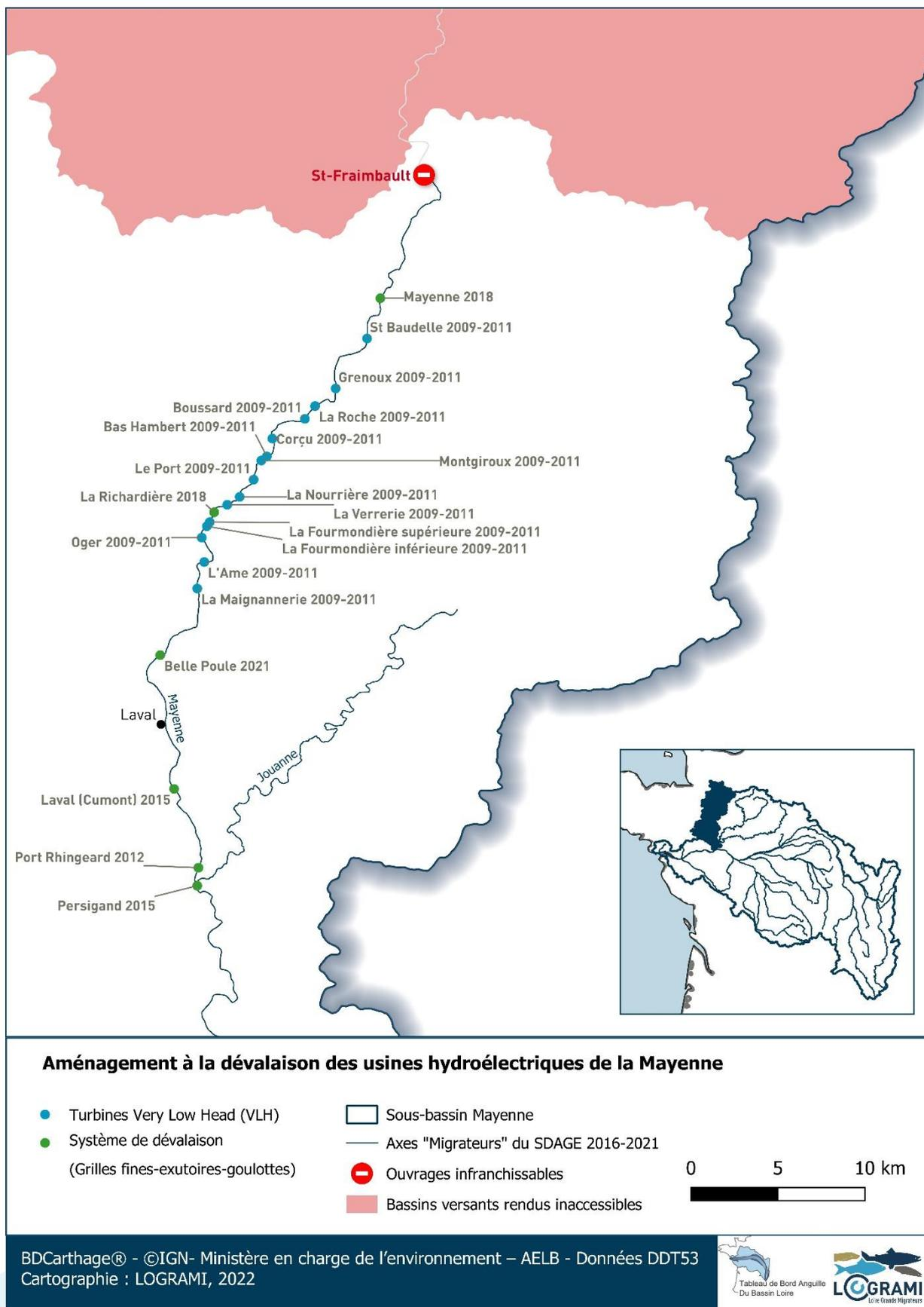
Figure 77 : Aménagements des ouvrages hydroélectriques pour la dévalaison réalisés sur l'axe Mayenne
