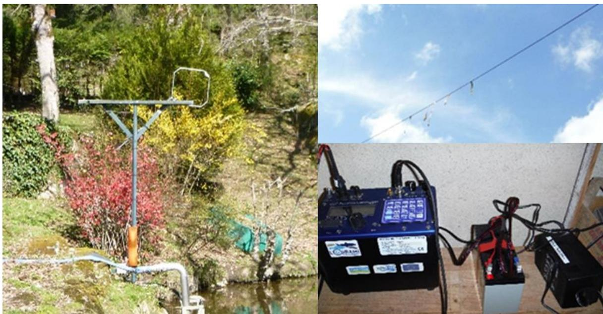
**Figure 113 : Eléments composant un poste de suivi fixe par radiopistage : antenne boucle, câble coaxial, récepteur et batterie d'alimentation (sources : LOGRAMI)**
