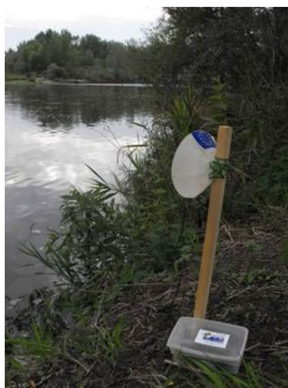
Figure 128 : Photographies du dispositif d'enregistrement audionumérique utilisé pour le suivi de la reproduction des aloses (LOGRAMI)
