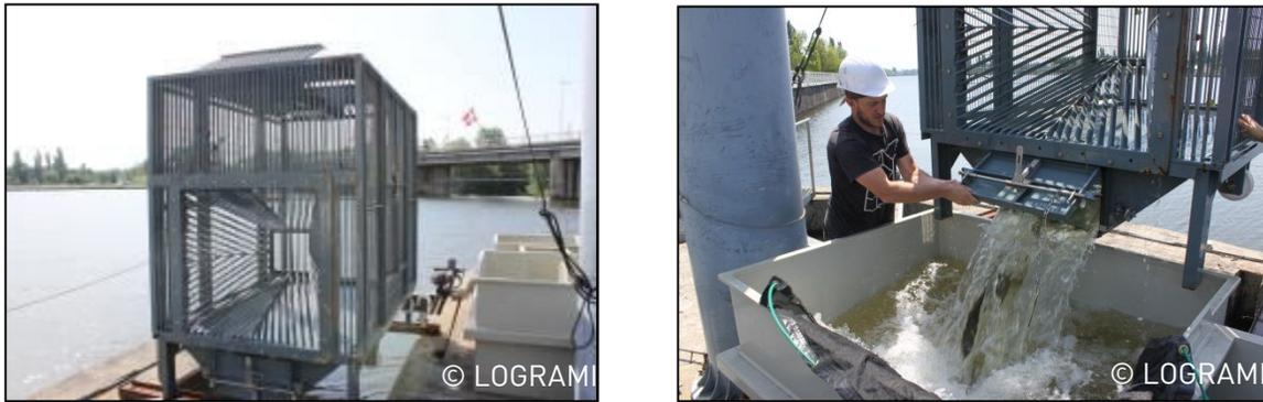
Figure 143 : Piège et structure de manipulation de la passe à poissons rive droite du pont barrage de Vichy
