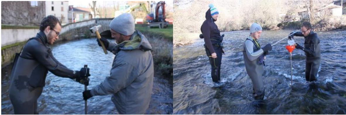
**Figure 63 : Mise en place et utilisation du piézomètre pour la mesure de la conductivité hydraulique**
