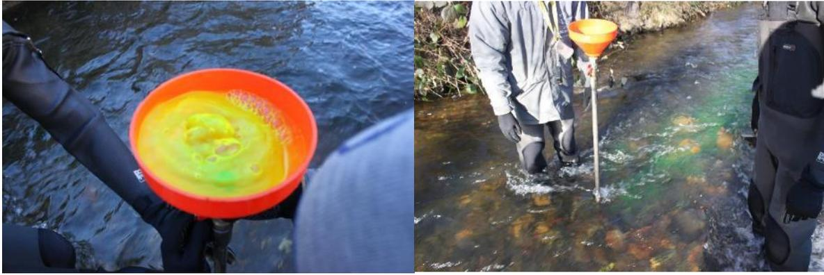
Figure 64 : Photographies illustrant la mesure du temps d'infiltration de l'eau dans le piézomètre
