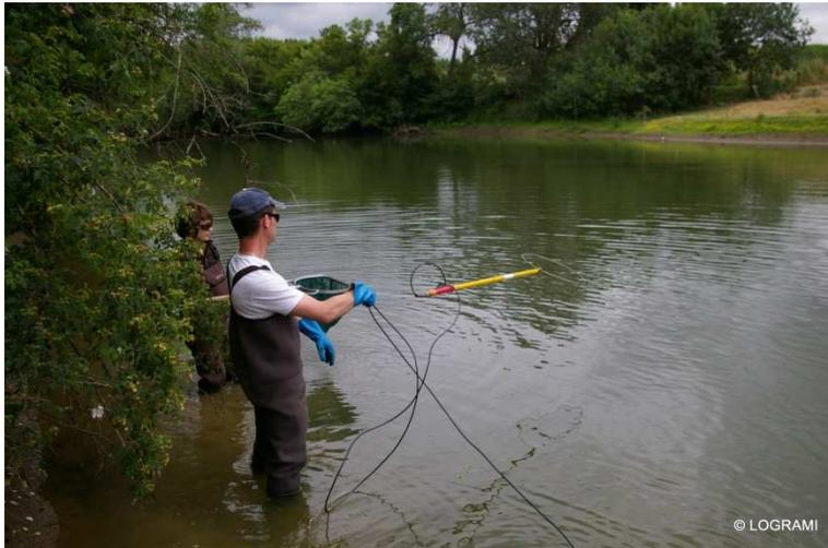
Figure 151 : L'anode est lancée pour éviter la fuite des poissons lors de l'arrivée sur le point de pêche (photo T. Besse 2010).
