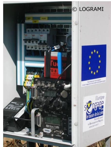
Figure 12: Dispositif poste fixe : couplage récepteur/enregistreur (Source LOGRAMI)
