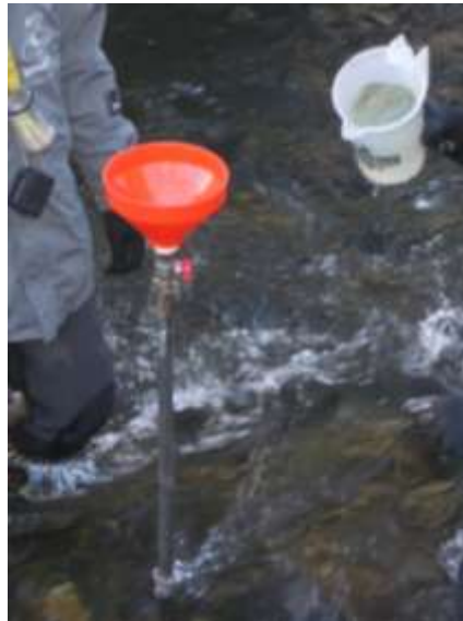
Figure 7 : Mise en place du piézomètre pour la mesure de la conductivité hydraulique dans une frayère artificielle de saumon atlantique (Source LOGRAMI)
