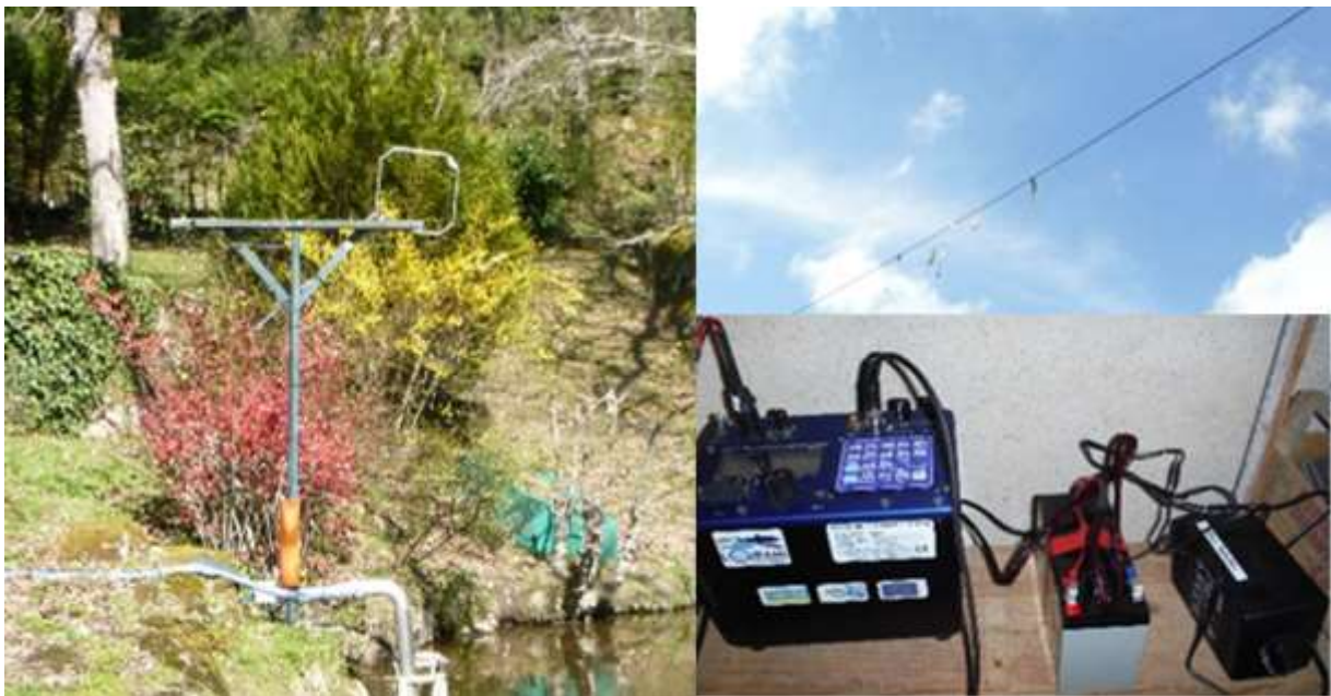
Figure 74 : Eléments composant un poste de suivi fixe par radiopistage : antenne boucle, câble coaxial, récepteur et batterie d'alimentation (Sources : LOGRAMI)
