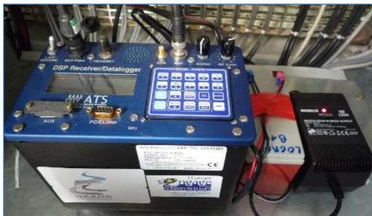
Figure 81 : Récepteur R4500C utilisé dans le cadre du suivi par radiopistage sur la rivière Gartempe en 2018
