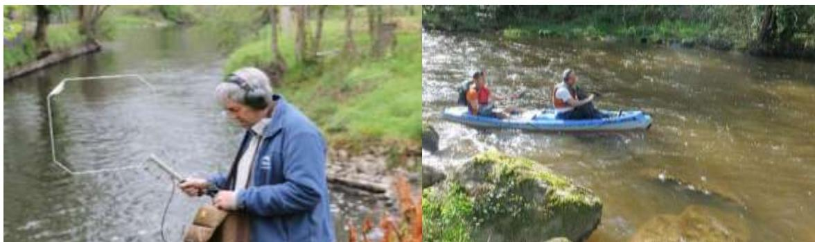
Figure 87 : Suivis radio télémétriques mobiles à pied avec une antenne boucle (à gauche) et en canoë (à droite)
