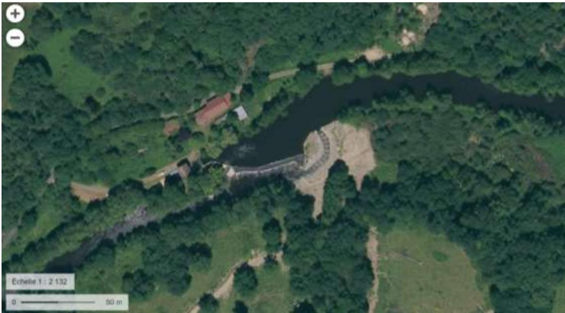
Figure 101 : **Vue aérienne du site de l'usine hydroélectrique de Roche sur la Gartempe avec l'usine en rive gauche et la passe à poissons en rive droite** (Source : Géoportail/IGN)
