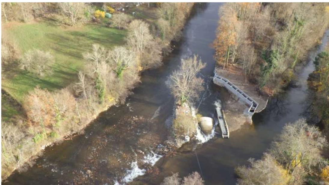
Figure 48 : Vue de dessus de la nouvelle passe à bassins successifs réalisée à l'Usine de Neuviel (en rive droite) sur la Sioule en 2018 (Source : LOGRAMI)
