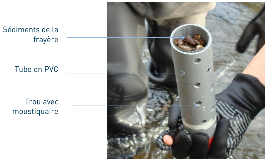
Figure 54 : Photographie d'un piège à sédiments (Source PTUT ENSAT)
