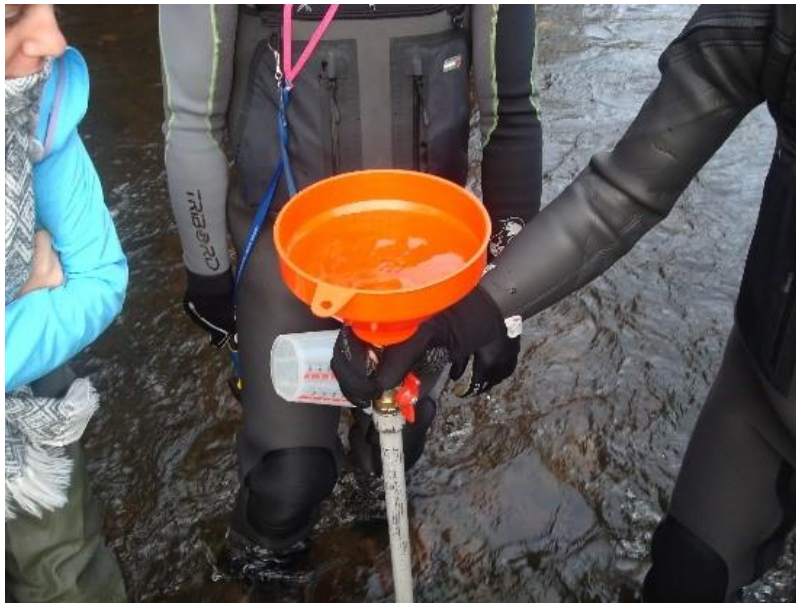
Figure 53 : Photographie illustrant la mesure du temps d'infiltration de l'eau dans le piézomètre (source PTUT, ENSAT)
